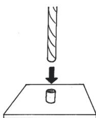
Innestare l'estremità del tubo in una base con raccordo
